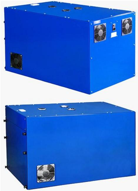
サイレントラボ消音エンクロージャーは、SEM、TEM、FIB-SEM システムに使用される真空ポンプおよび冷却水循環装置により発生するノイズレベルを低減するために開発されてきました。それらの電子顕微鏡の部屋に真空ポンプおよび冷却水循環装置が設置される場合、音響ノイズは少ない環境の方が、気が散らず仕事がはかどります。サイレントラボ消音エンクロージャーを使用すると、許容可能なレベルまで音響ノイズを低減し、オペレーターが手元の作業に集中することができます。サイレントラボ音響エンクロージャは騒々しい真空ポンプや冷却水循環装置の上に配置される洗練された、安全な防音ボックスです。電源供給や真空ポンプ排気ラインの接続が容易で、また、空冷ファンが付いているため、真空ポンプや冷却水循環装置は本エンクロージャーの取付け前と同様に動作させることができます。本来 SEM、TEM および FIB-SEM システム用に設計されていますが、ノイズの多いロータリーポンプなどを用いる他のシステムにも同様に有用です。
